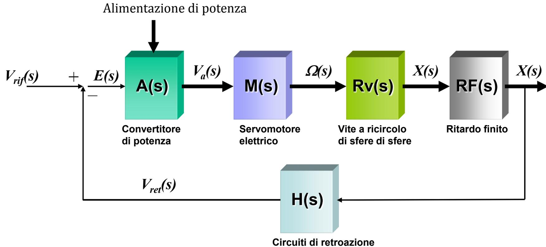
Il **ritardo finito** viene inserito nel **ramo diretto** in quanto il **ramo di retroazione** comincia con la lettura della variabile d'uscita da parte del sensore.
