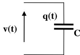
$$\text{Capacità} = \frac{\text{Carica}}{\text{Tensione}}$$
