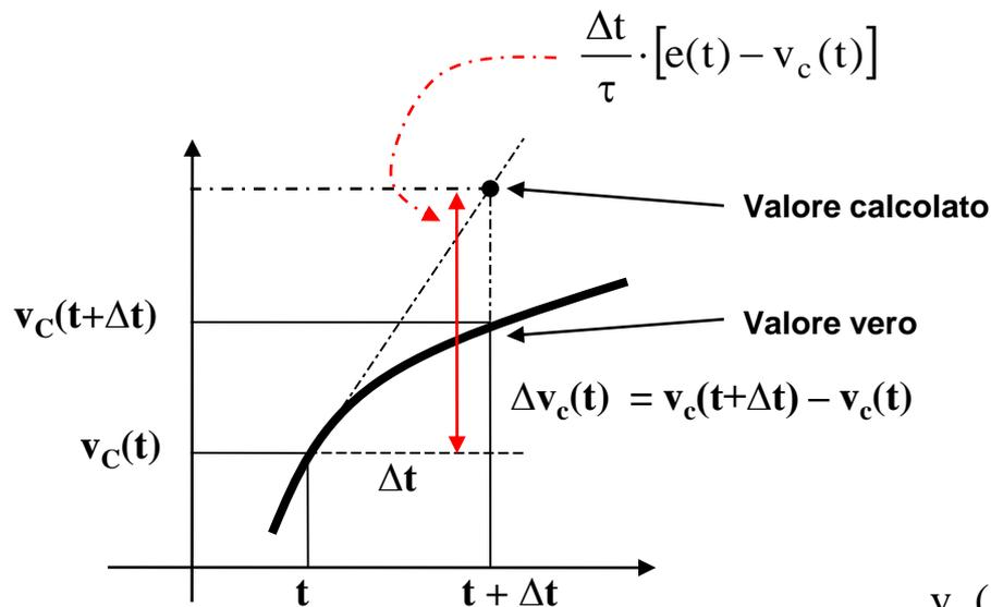
$$\tau \cdot \frac{\Delta v_C(t)}{\Delta t} + v_C(t) = e(t) \quad \text{Equazione alle differenze finite}$$
