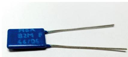
A strato ceramico (Cermet): resistenza tra 10 k $\Omega$  e un 1 T $\Omega$ ; tolleranza 1% ; potenza fino a 2 W.
