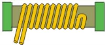
Per ridurre l'effetto induttivo si realizza un avvolgimento bifilare (avvolgimento *Ayrton-Perry*) in modo da annullare il flusso magnetico. Massima frequenza di utilizzo 100 kHz.
