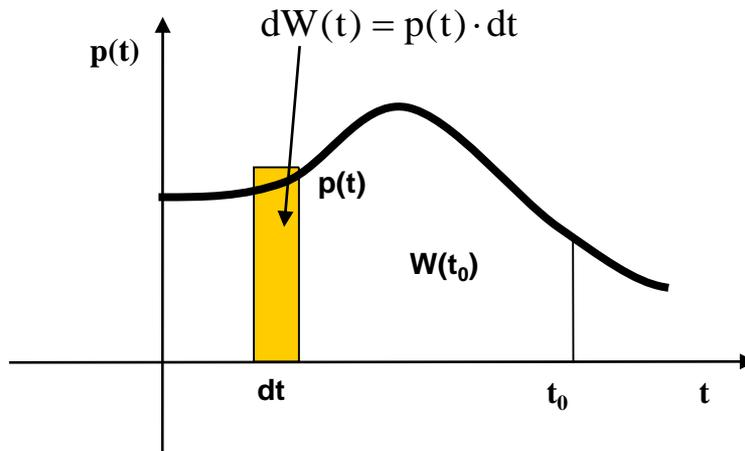
Per il calcolo di quest'area si può ricorrere al calcolo numerico:
