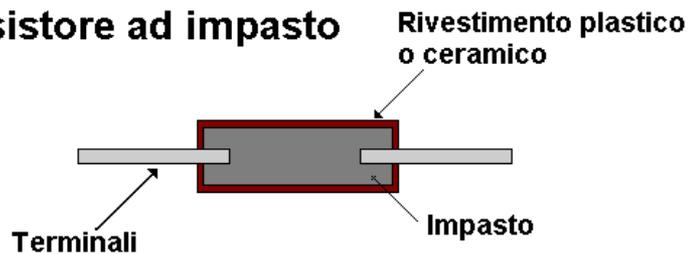
La resistenza è ottenuta per mezzo di una miscela di materiali isolanti e conduttori.
