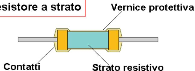
La resistenza è ottenuta per mezzo di una sottile pellicola resistiva avvolta su un supporto isolante. Sulla pellicola viene praticato un solco a spirale lungo tutto il cilindro.
