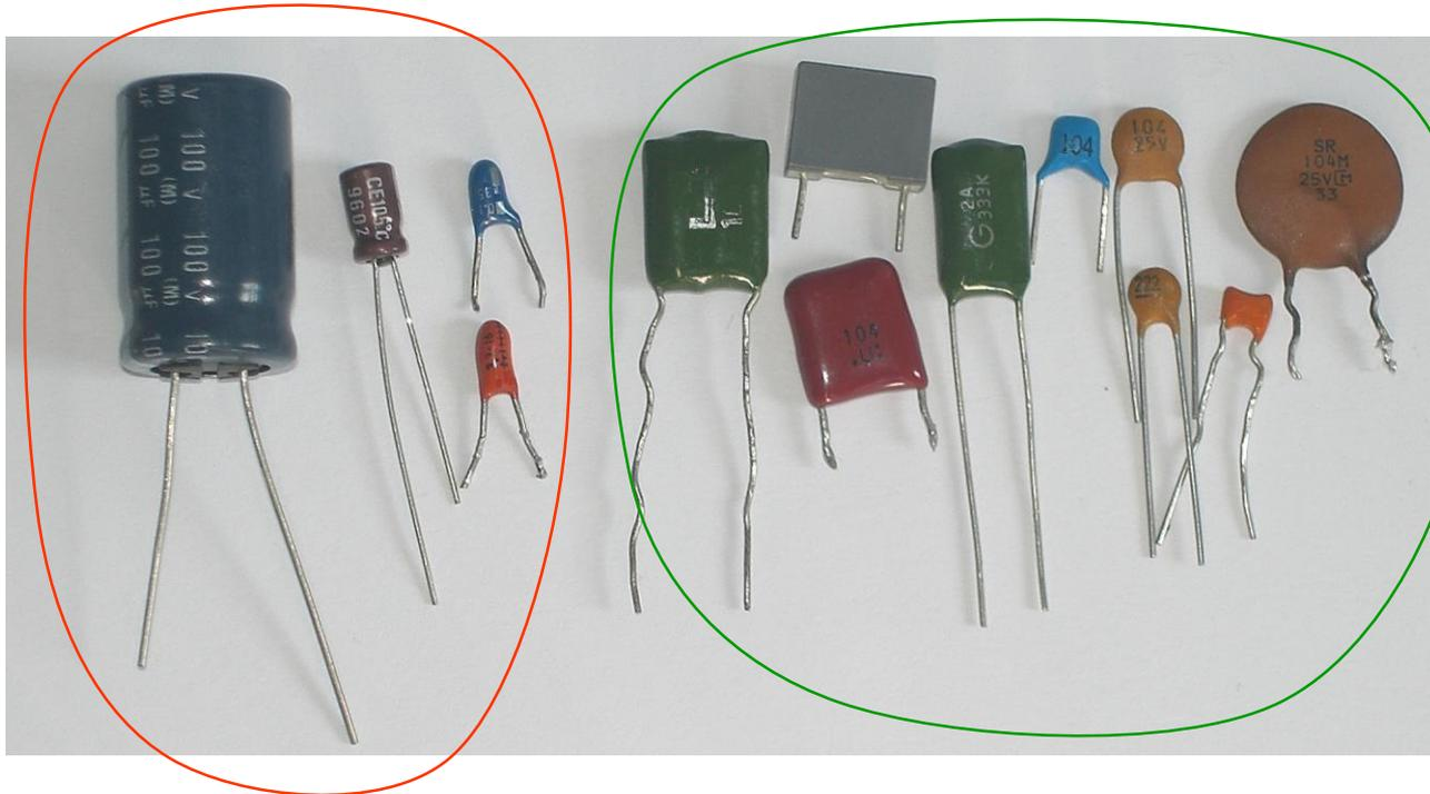
**NB:** In un circuito in c. a. si devono usare condensatori non polarizzati.
