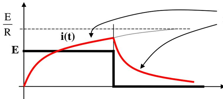
$$i(t) = (i_{\text{FIN}} - i_{\text{IN}}) \cdot \left( 1 - e^{-\frac{t}{\tau}} \right) + i_{\text{IN}}$$
