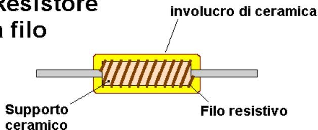
La resistenza è ottenuta per mezzo dell'avvolgimento di un filo metallico avvolto su un cilindro isolante (max 100 k $\Omega$ ):
