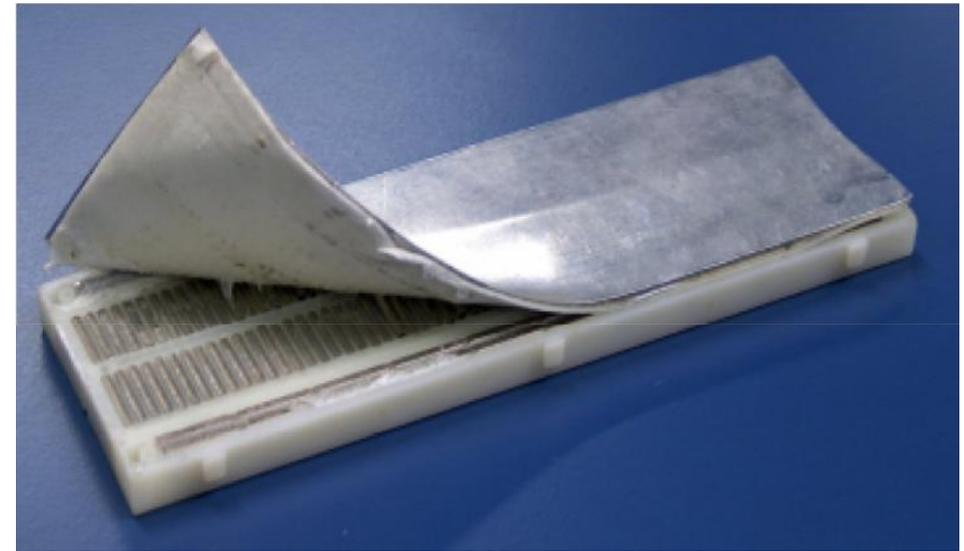
La distanza tra i fori è pari a 2.54 mm (0.1"), compatibile con i circuiti integrati DIP.
